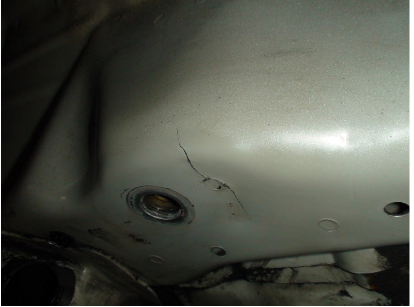
Bmw E46 Subframe Cracking
